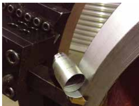
Alta taxa de remoção de metal em tuba de aço P91
