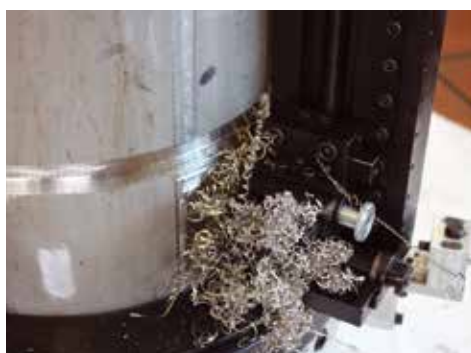
Remoção longitudinal de costura de solda
