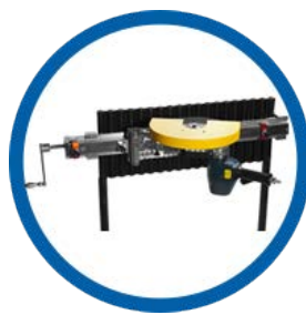
Corte painel de tubos
